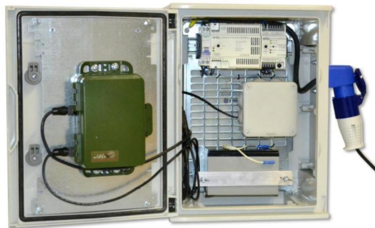
Figure 146 : Illustrations d'un dispositif d'écoute automatique des chauves-souris pour éolienne
